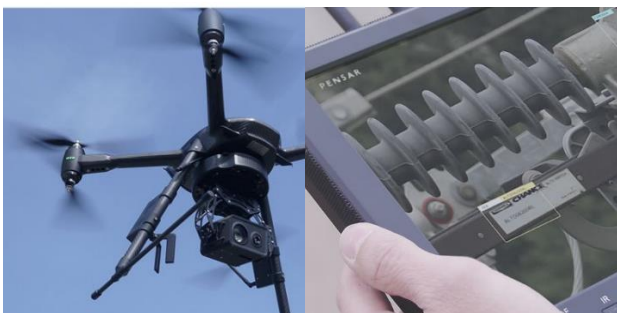
Figure 4 : Surveillance de câble par Aerialtronics [9]
