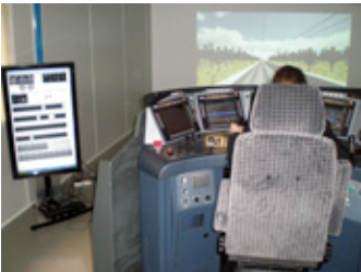
FLO, simulateur du comportement d'un convoi ferroviaire (vue partielle)
