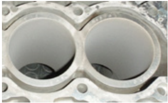
Revêtement projeté par torche à plasma à la surface de cylindres d'un bloc moteur automobile
